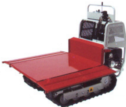
CASSONE DUMPER CON SPONDE APRIBILI BODY WITH OPENABLE BOARDS R 70 - R 70 PLUS
